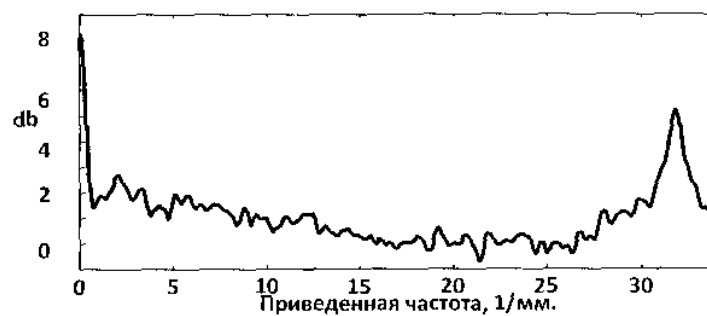
Рисунок 4 - Амплитудный спектр профиля поперечного сечения внутренней поверхности трубы размером 9,1×0,7 мм из сплава Zr1Nb.
