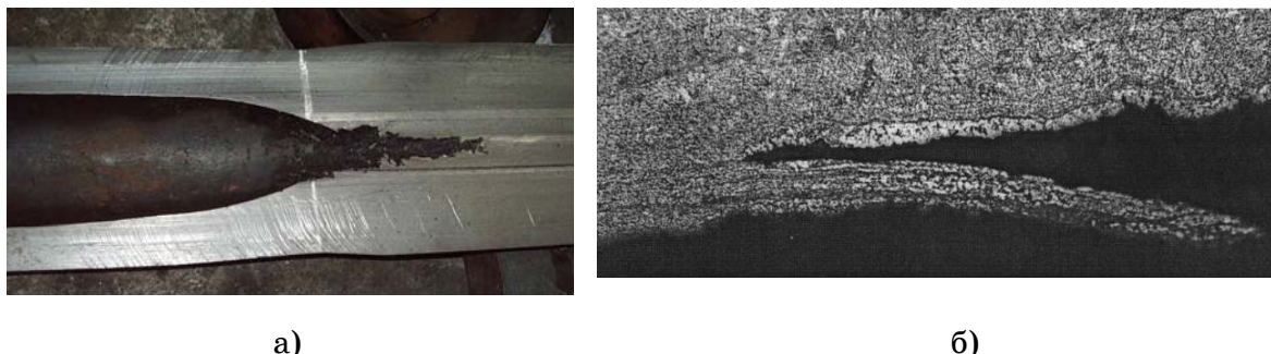
Рисунок 1 – Образование внутренней полости при прошивке слитков (а) и дефект в виде внутренней плены (б)
