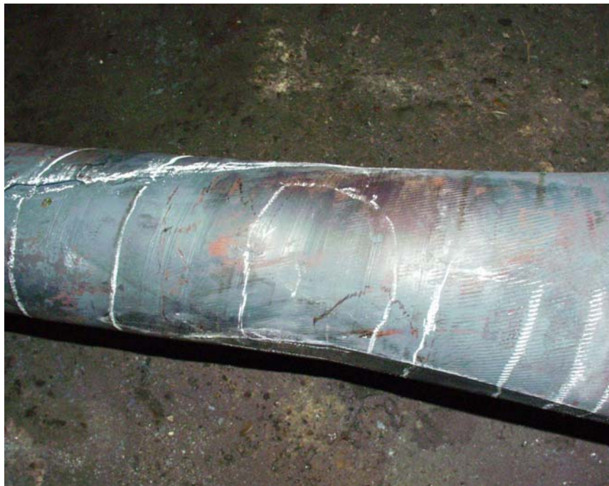
Рис. 1. - Продольные широкие вдавы спирального вида, обусловленные применением штатных линеек и оправок для бочковидных валков
