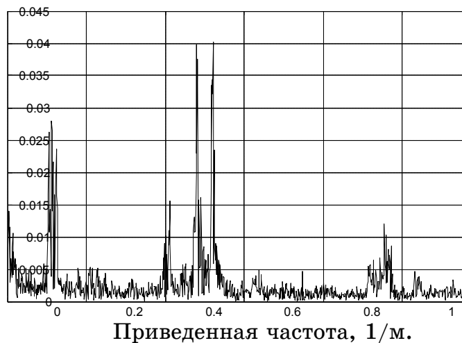
Рисунок 3 - Амплитудно-частотные характеристики отклонений толщины стенки трубы размером 168×7,0 мм.
