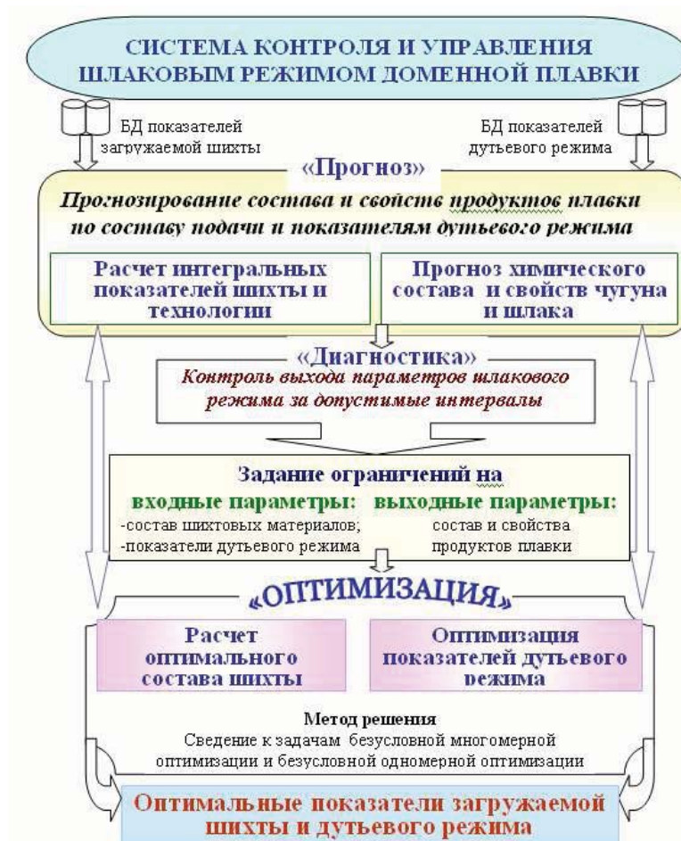
Рисунок 1 – Структурная схема автоматизированной системы «Шлак»
