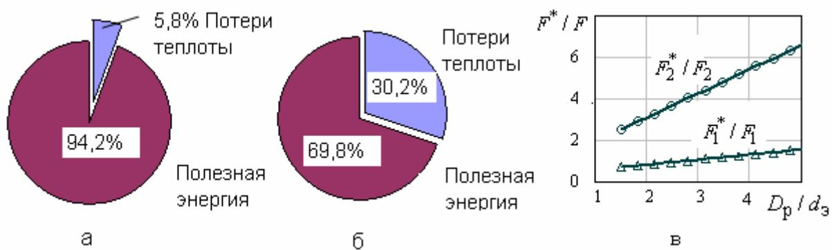
Рисунок 2 – Теплоэнергетические показатели процесса плавления шихты в индивидуальных колодцах (а) и общем колодце (б). Изменение геометрии колодцев при варьировании  $D_p / d_3$  (в). Обозначения – в тексте и на рис. 1
