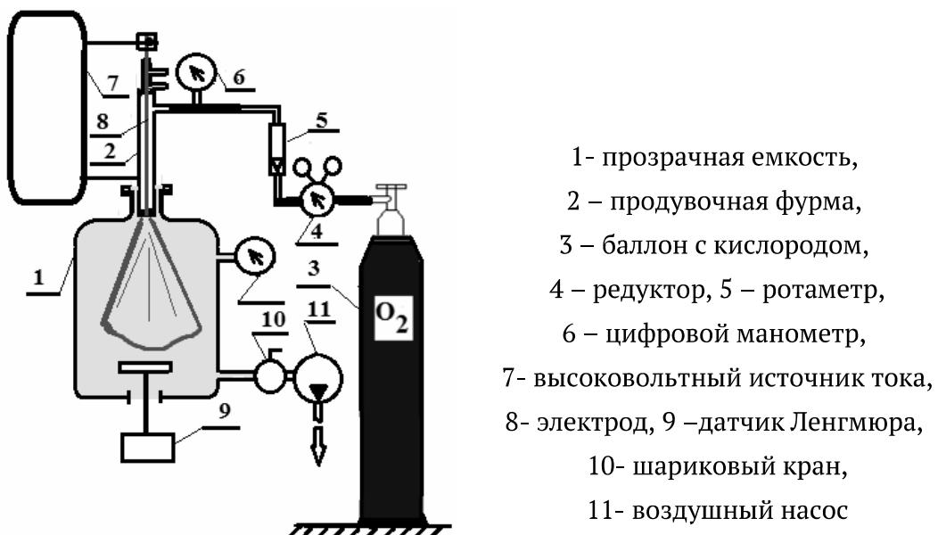
Рисунок 1 – Функциональная схема стенда физического моделирования
