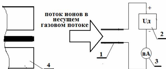
1- пластины датчика, 2- – блок питания датчика,
