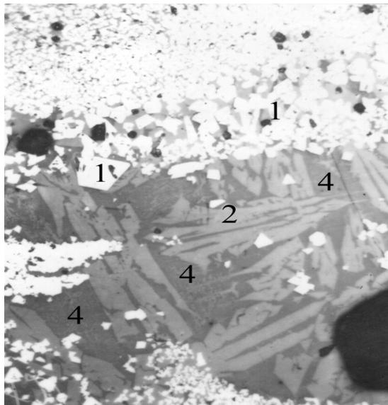
1 – гаусманит; 2 – тефроит; 3 – твердый раствор  $2\text{MnO}\cdot\text{SiO}_2$  -  $2\text{CaO}\cdot\text{SiO}_2$ ; 4 – стекло; 5 -  $\text{CaO}\cdot\text{MnO}$ ; 6 –  $\text{CaO}\cdot\text{Mn}_2\text{O}_3$ ; 6 –  $\text{CaO}\cdot\text{Mn}_2\text{O}_3$
