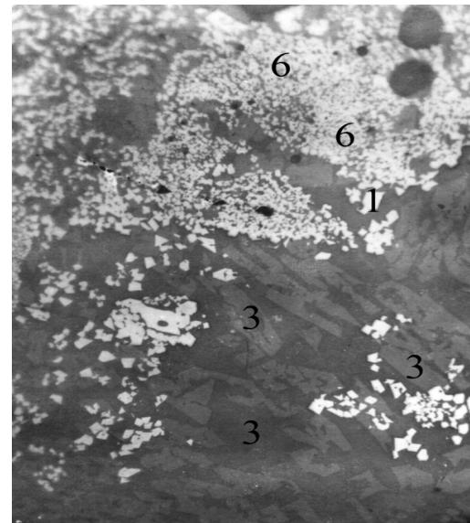
Рисунок 4 – Минералогический состав агломерата с подщихтовкой известняка, основность 0,6;
