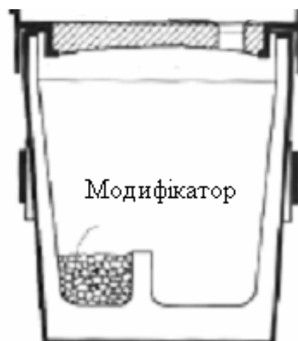
Рисунок 2 – Введение модификатора «сэндвич – процессом»
