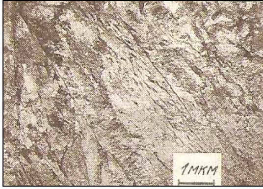
Рисунок 2 – Структура стали 35ГС после деформационного старения бейнита \times 500
