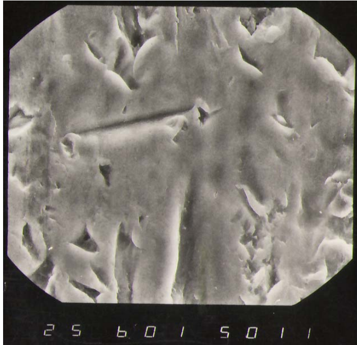
Рисунок 2 – Единичный микрорельеф в начале обработки
