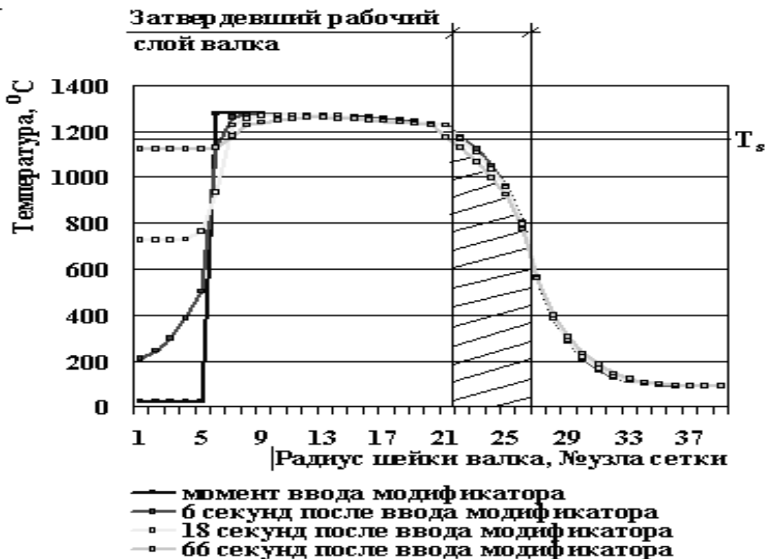
Рисунок 3 - Изменение температуры по радиусу валковой формы после модифицирования
