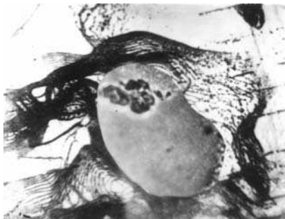
Рисунок 3 – Пластическая релаксация напряжений вблизи включения при лазерном воздействии; \times 500
